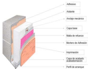
Esquema fachada SATE
