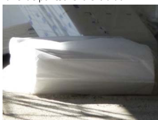
Planchas de poliestireno expandido para suelos radiantes
