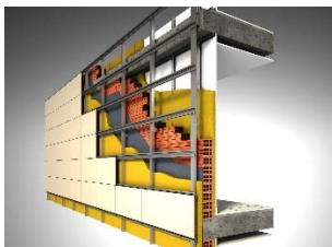
Paneles aislantes y fachada ventilada
